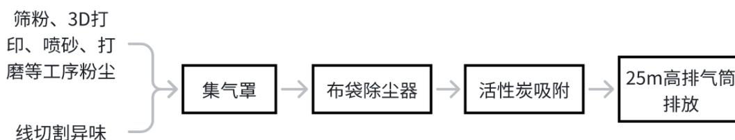
图 4.2-2 生产废气有组织排放处理工艺流程图
